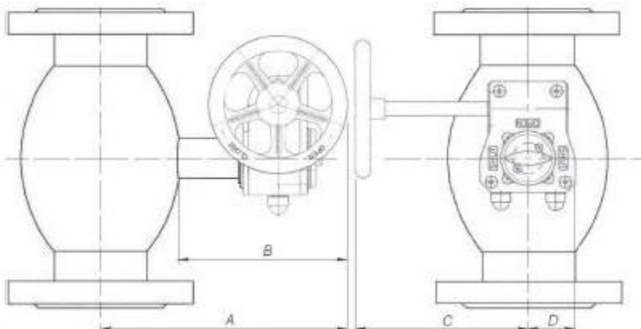
**Технические характеристики шаровых кранов LD с механическим редуктором ProGear**
